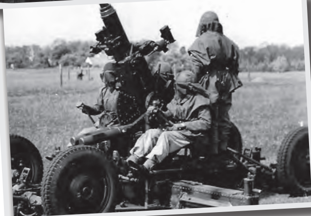
Tidigt 50-tal övar dessa luftvärnare med en 40 mm lvkanon m/36. OBS! att servisen är klädd i förstärkt klädsel med ansikte, nacke helt skyddade mot värmestrålningen av hjälmduket. En följd av det allt mer aktuella atombombshotet
