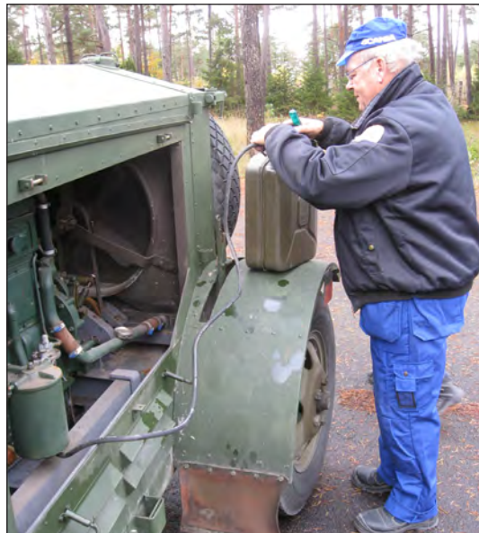
Bertil kopplar bensinen direkt till motorn, slang för ändamålet fanns behandligt på en kp-bil i förrådet.
