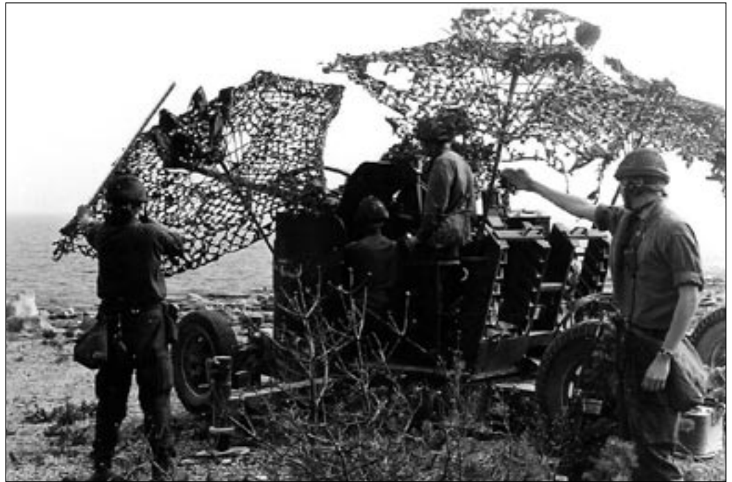
Pjäschefen/eldledaren pekar ut målet och pjäsmannen t.v. med framförhållningsmätkäppen läser framförhållningsvinklarna till riktaren.
