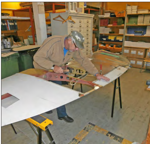
AN-2:ans sidoroder användes att se om "omdukning" var möjlig. Lasse Boström popnitar offsetplåtar.
