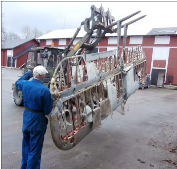
Den helt avklädda stabilisatorn på väg till uppvärmd lokal för att kläs med plåt. Lars-Erik Thor bistår Lasse Larsson som kör fordonet.
